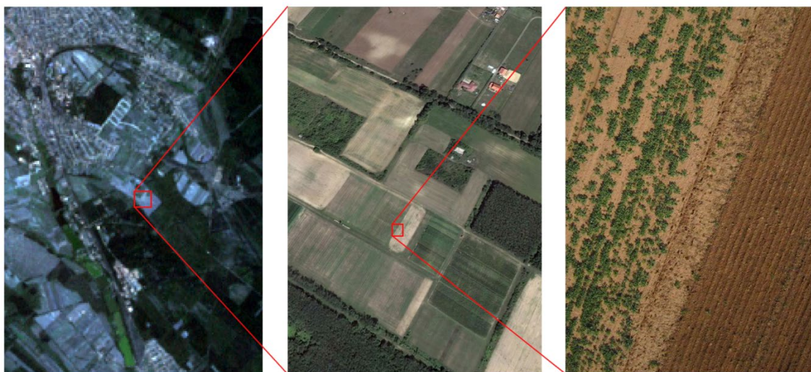
7. ábra Távérzékelési adatok térbeli felbontásának változása az érzékelő platform alapján (balról jobbra: műholdas, repülő, pilóta nélküli légi járműves távérzékelés)
