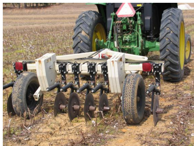
Kontakt talajszkenner sematikus ábrája és fényképe
