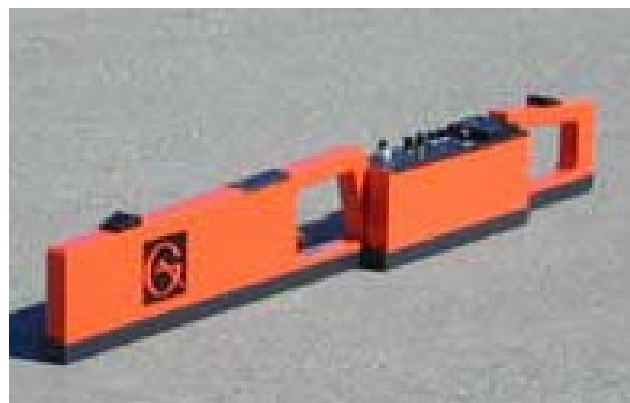
Elektromágneses indukción alapuló talajszkenner sematikus ábrája és fényképe
