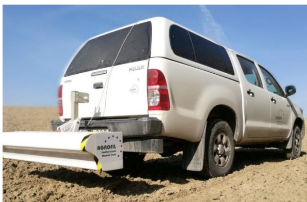
Talajszkenner erőgépre és terpjárra erősítve a különböző felhasználási terület szerint
